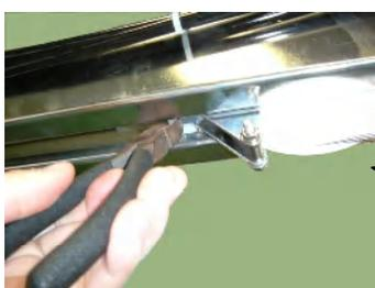
第2アーム軸側滑車にジャンピング防止装置が付いています。結束バンドをカットすることにより装置が有効になります。
