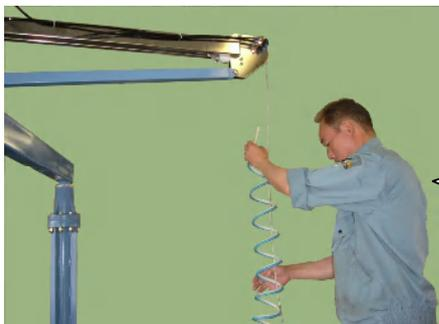
付属のスパイラルホースに第2アームのワイヤーロープを通し、第2アーム先端部継手にスパイラルホースをしっかりと接続します。
