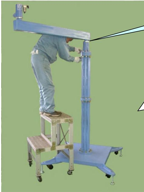
アルミ製リングの側面にブレーキトルク調整用の穴付ボルトがあります。
