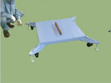
指定の位置に台座を設置し、四隅アジャスタボルトで水平調整し、キャスターが浮いた状態にします。
