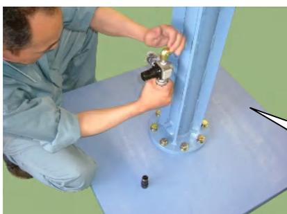
付属の入口弁をねじ込み固定してください。
