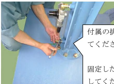
付属の排気弁をねじ込み固定してください。
