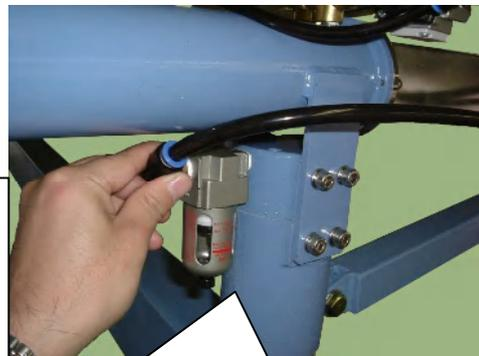
ホースを第1アーム先端部の継手にしっかりと接続します。
